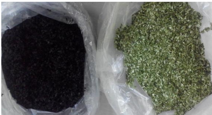
شکل ۳-۲- برگ سنجد و بیوچار تهیه شده از آن
