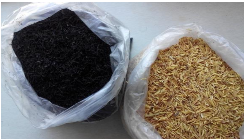
شکل ۱-۳- سبوس برنج و بیوچار تهیه‌شده از آن
