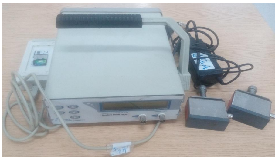
شکل ۳-۱۴ دستگاه دبی سنج (التراسونیک)
