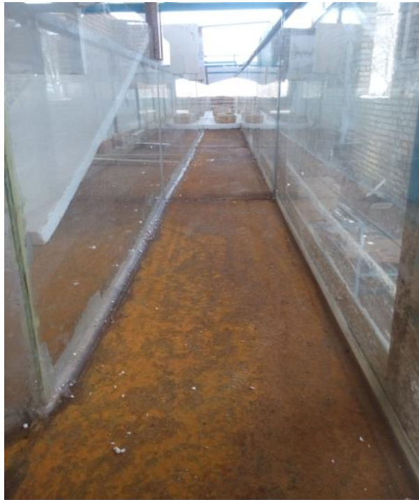
شکل ۳-۱۵ کم کردن عرض فلوم با شیشه
