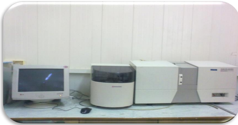
شکل ۳-۳: دستگاه اندازه‌گیری اندازه ذرات مدل Wing Sald 2101 برای اندازه‌گیری قطر متوسط ذرات.
