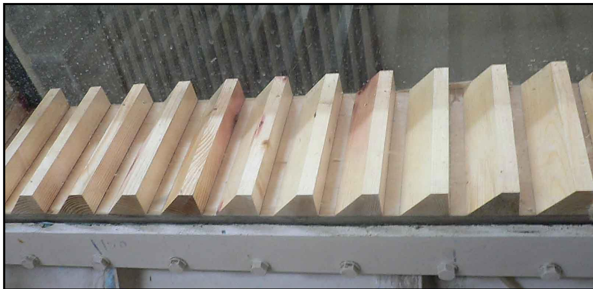
شکل ۳-۴- نمونه‌ای از کف زبر نصب شده در کانال (راور و همکاران، ۱۳۸۹)
