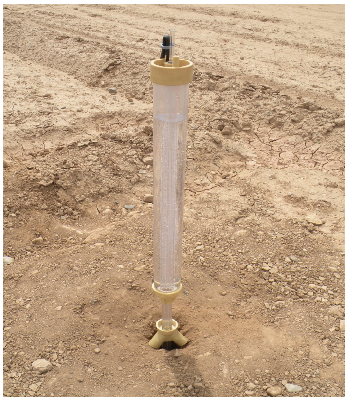
شکل (۳-۴) نصب دستگاه گلف جهت اندازه گیری هدایت هیدرولیکی اشباع در اعماق مختلف
