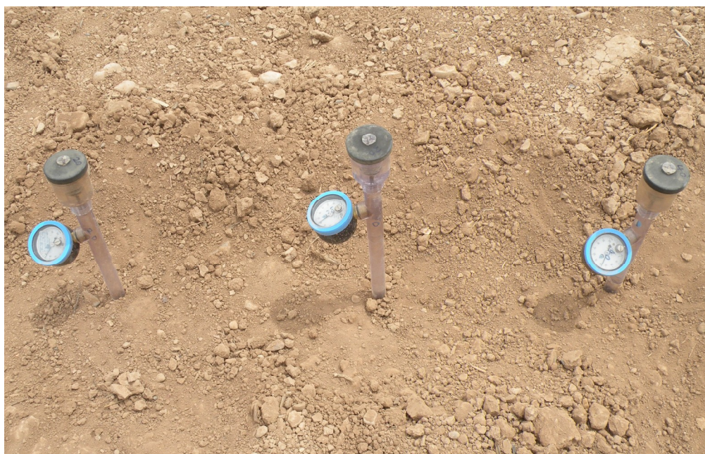
شکل (۳-۵) نصب تانسیومتر برای اندازه گیری رطوبت خاک
