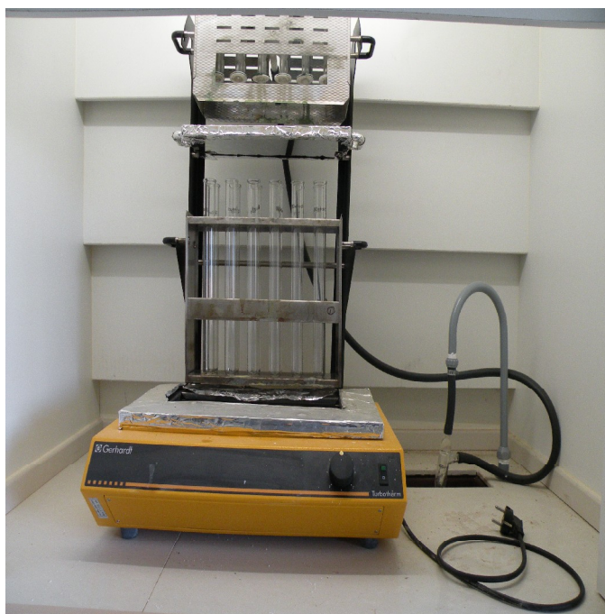
شکل (۳- ۸) بخش هضم از دستگاه کج‌دال برای اندازه گیری نیتروژن
