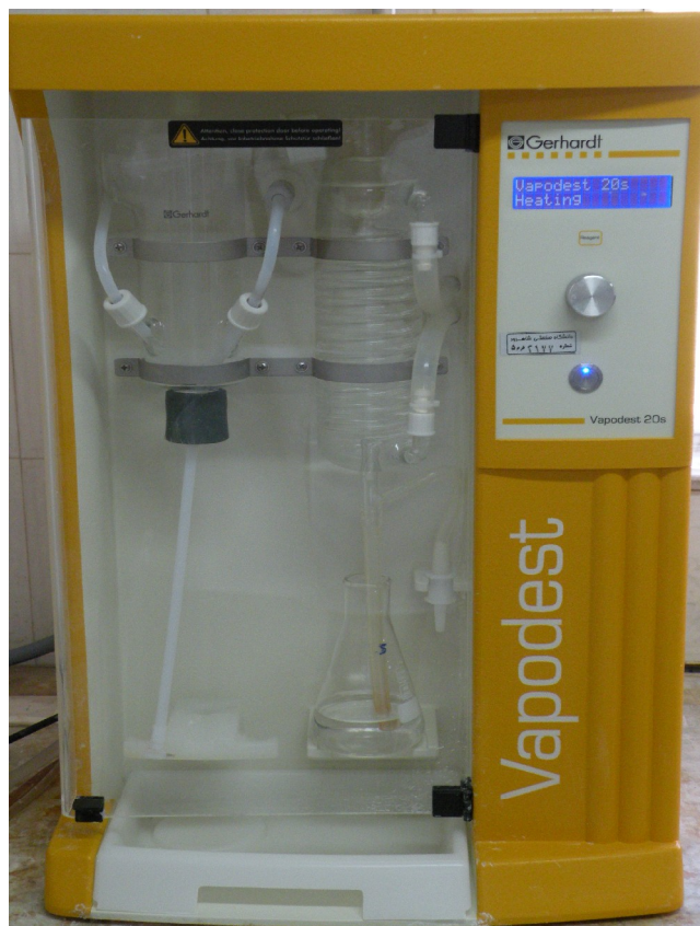
شکل (۳- ۹) بخش تقطیر از دستگاه کج‌دال برای اندازه گیری نیتروژن
