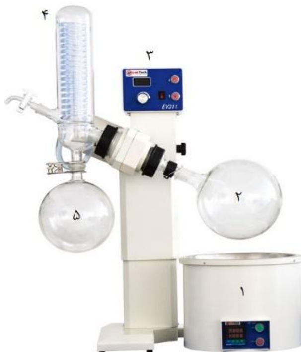
شکل ۱-۴: دستگاه تبخیر کننده تحت خلا. بالن حاوی محلول پلی ساکاریدی (۱)، مخزن آب گرم (۲)، موتور (۳)، تقطیر کننده یا کندانسور (۴)، بالن جمع آوری مواد تقطیر شده (۵) (۴۵).
