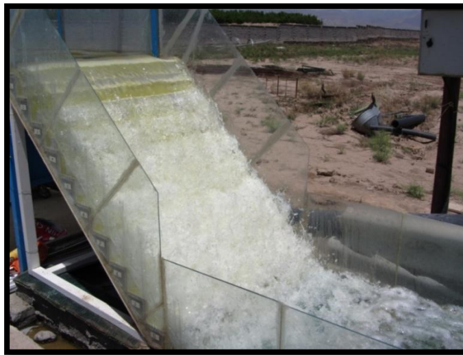
شکل ۳-۵- رژیم جریان ریزشی برای دبی ۲۵ لیتر بر ثانیه
