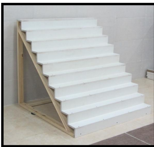
شکل ۳-۳- سرریز پلکانی با عرض و ارتفاع یک متر (قبل از نصب)
