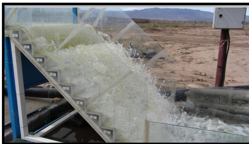
شکل ۴-۱- رژیم جریان ریزشی بر روی سرریز پلکانی بدون لبه
