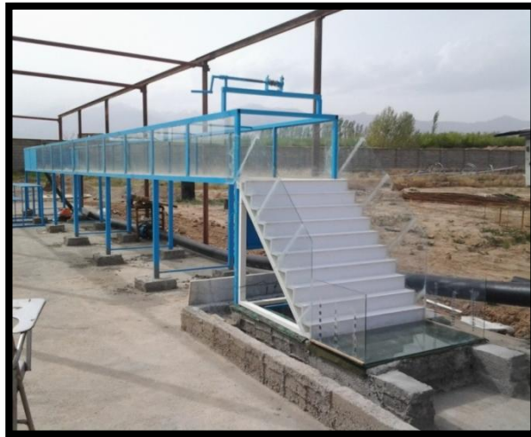
شکل ۳-۴- سرریز پلکانی با عرض و ارتفاع یک متر (بعد از نصب)
