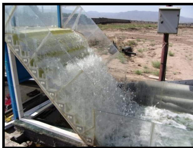
شکل ۳-۶- رژیم جریان ریزشی برای دبی ۲۵ لیتر بر ثانیه و سرریز با لبه ۵ سانتی متری در ابتدا و وسط پله
