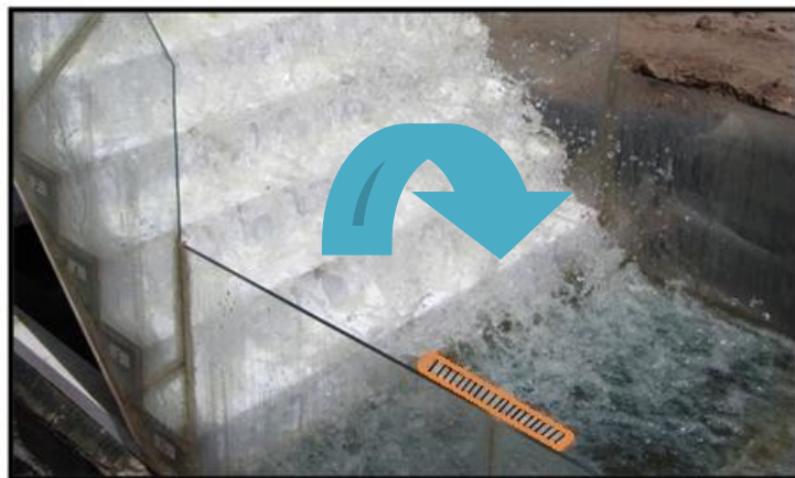
شکل ۴-۲۰- نمایی از محل اندازه‌گیری فاصله طولی سقوط آب در حوضچه آرامش
