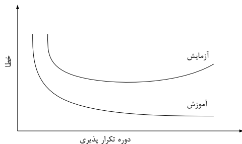
شکل ۲-۱۰ تغییرات خطای شبکه در مراحل آموزش و آزمایش در صورت وجود پدیده overtraining
