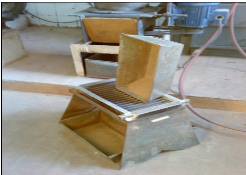
شکل ۳-۳ نحوه هدگیری و جدایش همگن نمونه‌های خاک
