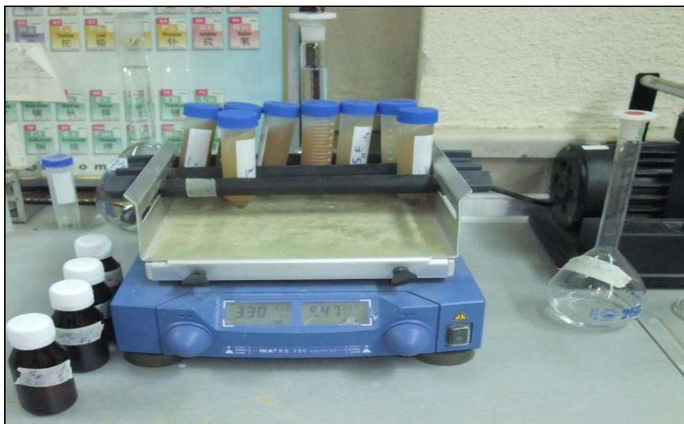
شکل ۳-۵ قرارگیری تیوب‌ها بر روی دستگاه لرزاننده در آنالیز استخراج ترتیبی
