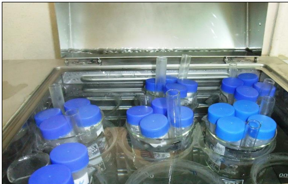
شکل ۳-۶ قرارگیری تیوب‌ها در حمام آب در آنالیز استخراج ترتیبی
