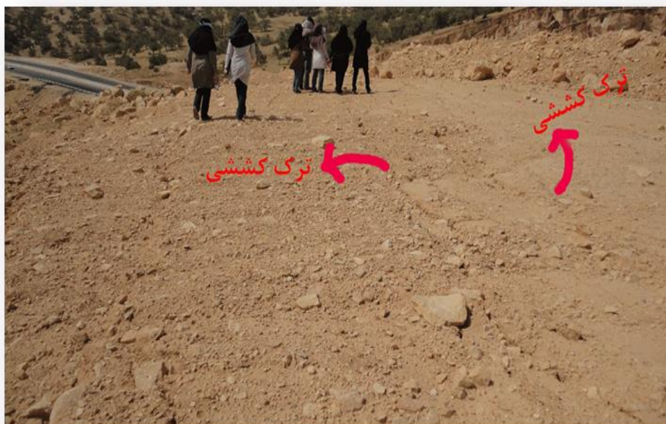
شکل (۳-۲۴) - ترکهای کششی در کیلومتر هشت آزادراه که نشانه فعال بودن زمین لغزش می‌باشد.
