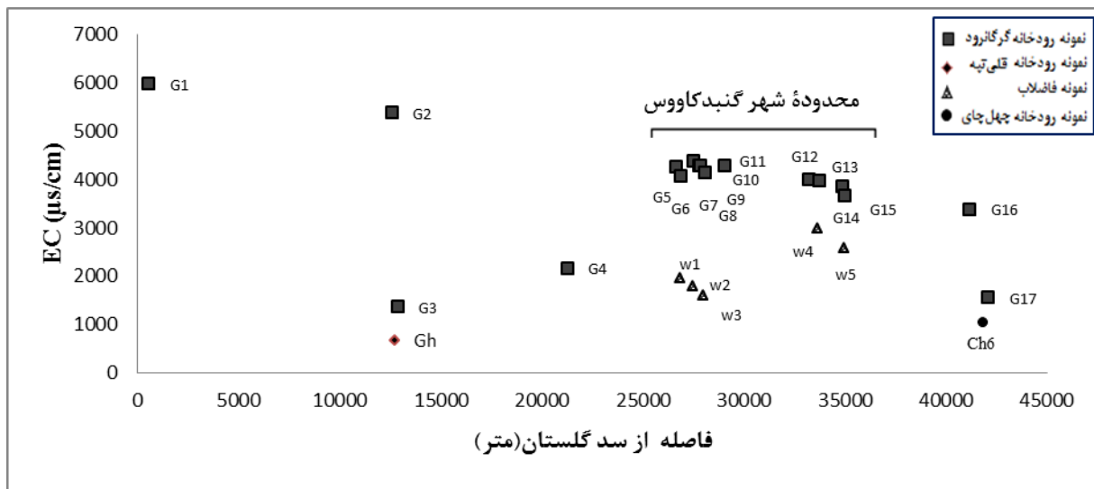
شکل ۴-۲- روند تغییرات هدایت الکتریکی (EC) در نمونه‌های آب رودخانه گرگانرود (هدایت الکتریکی شاخه فرعی قلی تپه و فاضلابهای ورودی به رودخانه نیز در این شکل ارائه شده است)
