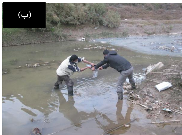
شکل ۳-۲- نمونه برداری از الف) آب ب) رسوب بستر
