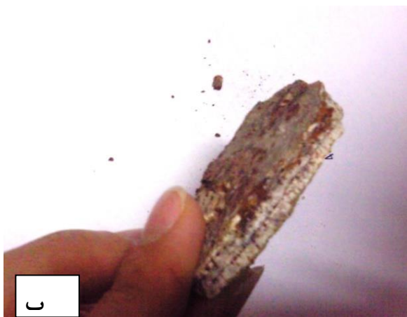
شکل ۴-۶- الف) نمایی از شکستگی‌های سطحی پر شده توسط رس. ب) نمای نزدیک از مواد پرکننده درزه‌ها در جناح چپ که علاوه بر رس حاوی مقداری ژئیس با پوشش زنگ‌زدگی می‌باشد.
