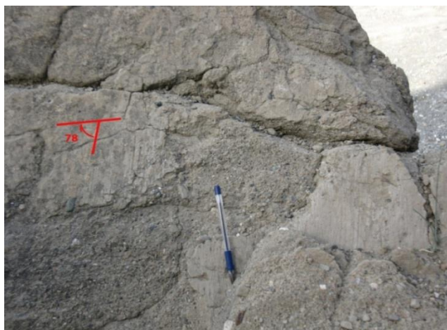
شکل ۳-۲۳- ریک خش لغز با جهت یابی 78SW در صفحه گسلی برداشت شده در مسیر رودخانه میناب که در شکل ۳-۲۴ الف نشان داده شده است. (دید به سمت شمال).
