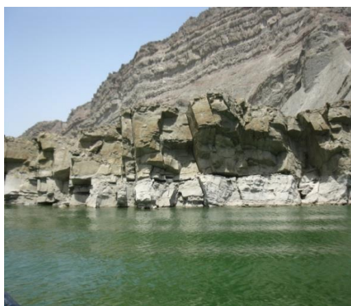
شکل ۴-۲- درزه‌داری و گسل خوردگی یال خاوری تقادیس میناب در محدوده مخزن سد میناب. الف) گسل معکوس در لایه‌های مارن با درون لایه‌های ماسه‌سنگی در بخش خاوری مخزن. ب) درزه‌داری لایه‌های ماسه‌سنگی در یال خاوری تقادیس میناب و در محدوده مخزن سد.
