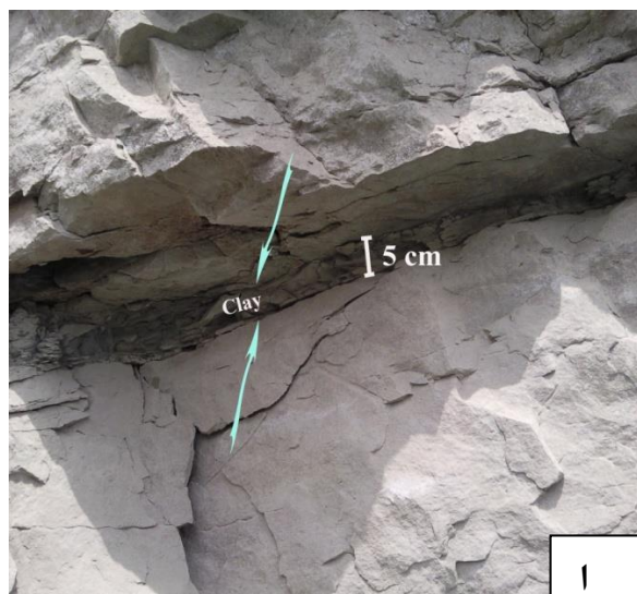
شکل ۴-۶- الف) نمایی از شکستگی‌های سطحی پر شده توسط رس. ب) نمای نزدیک از مواد پرکننده درزه‌ها در جناح چپ که علاوه بر رس حاوی مقداری ژئیس با پوشش زنگ‌زدگی می‌باشد.
