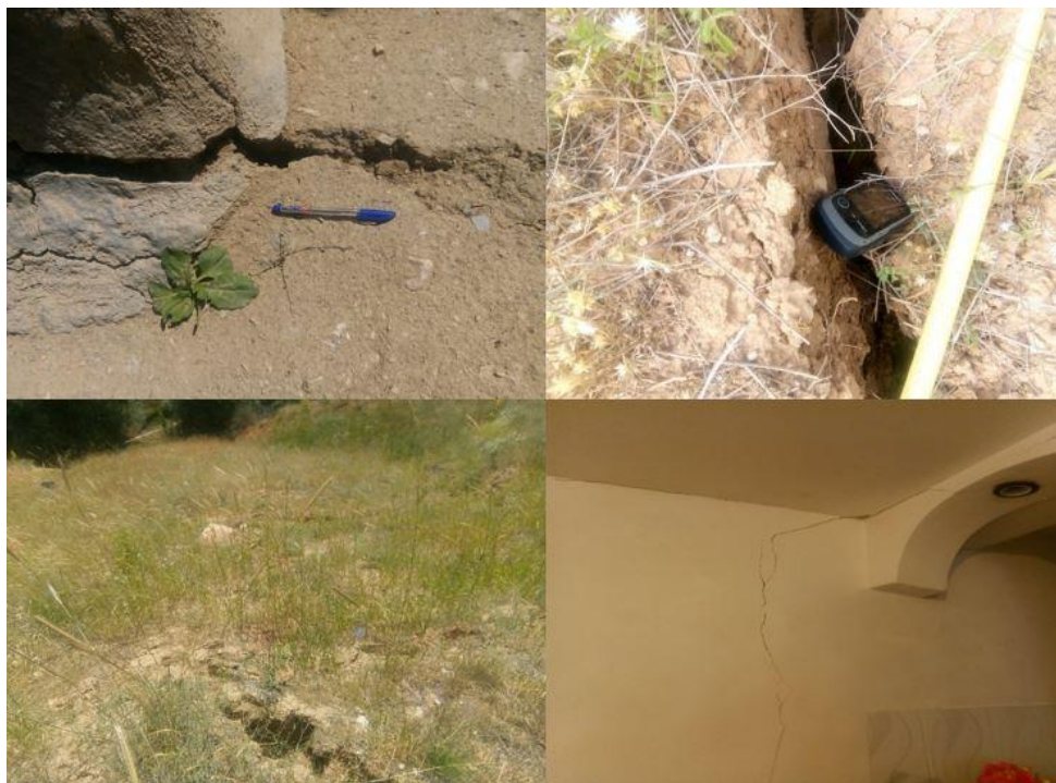
شکل ۴-۳۲: آثار ترک‌های کششی مشاهده شده در پروفیل B و C
