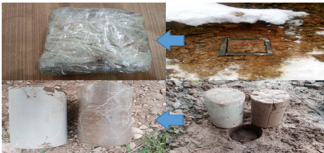
شکل ۳-۲: تهیه نمونه‌های دست نخورده در محل زمین لغزش توسط قالب مخصوص و مهر و موم آن‌ها
