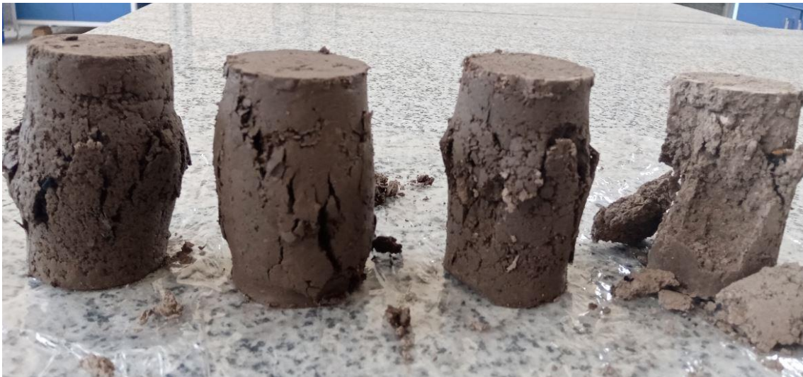
شکل ۴-۲۱: شکل‌های مختلف گسیختگی بعد از بارگذاری و اتمام آزمایش در نمونه ۱
