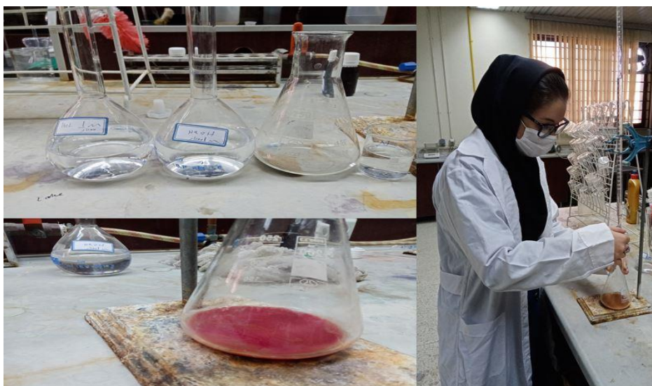
شکل ۳-۹: تیتراسیون نمونه خاک توسط اسید کلریدریک و سود یک نرمال
