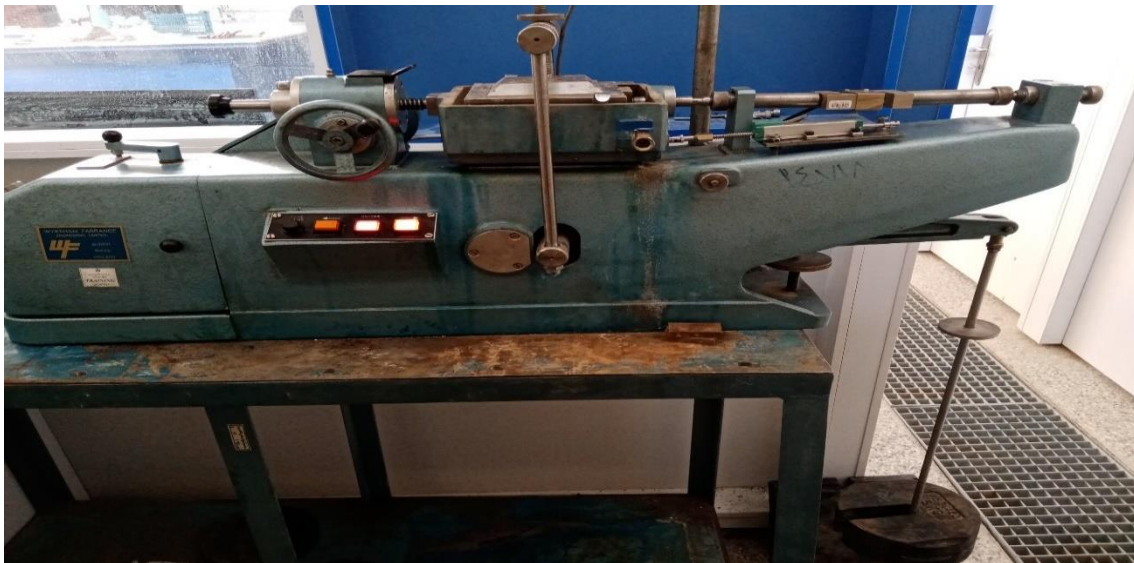
شکل ۳-۱۱: نمایی از دستگاه برش مستقیم در حین انجام آزمایش و برش نمونه
