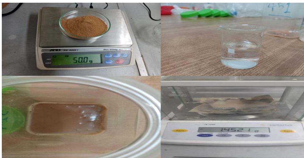
شکل ۳-۱۰: اندازه‌گیری میزان کربنات کلسیم به روش وزنی با مقدار رسوب اولیه ۵۰ گرم
