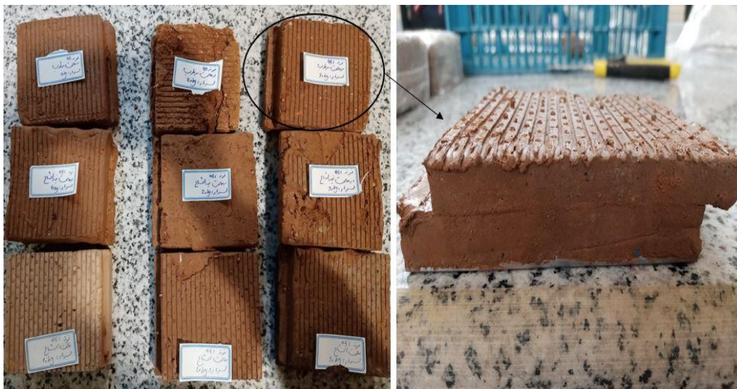
۴-۱۵: نمونه ۳ بعد از برش و اتمام آزمایش به همراه نمایی از مقدار جابه‌جایی اعمال شده بر روی نمونه‌ها
