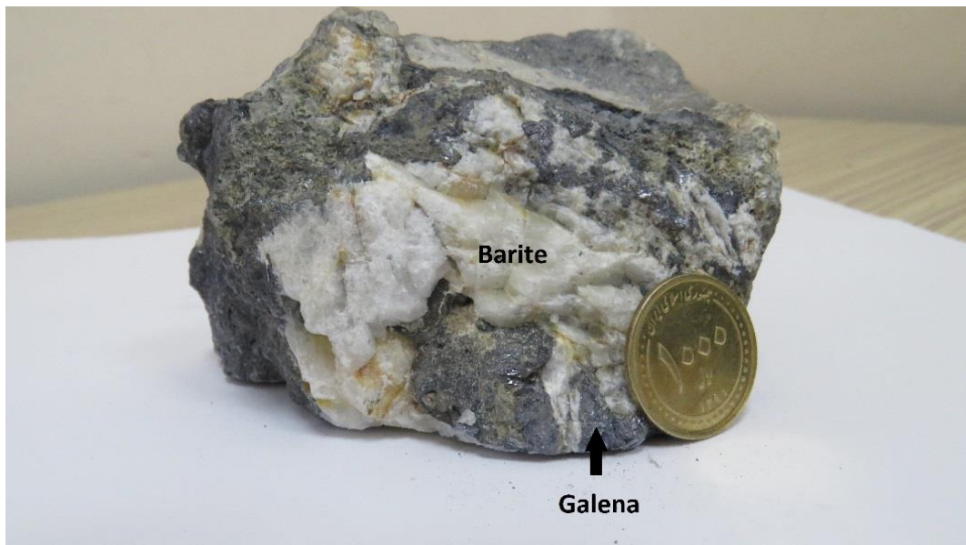
شکل ۱-۷- باریت به همراه گالن در یک نمونه دستی از معدن سرب دونا
