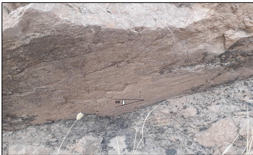
شکل ۳-۴۰- تصویر روی زمین از سطح گسل F 6 همراه با موقعیت خراش های گسلی و پله های گسلی ایجاد شده در سطح گسل (نگاه به سمت خاور)
