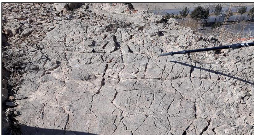
شکل ۳-۵۰- تصویر صحرایی از شکستگی های برداشت شده از ایستگاه ۱ بر روی چین خوردگی سازند دلیچای
