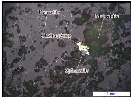
شکل ۴-۱۲- حضور مالاکیت سبز رنگ در مقطع صیقلی همراه با کالکوپیریت، لسفالریت و هماتیت به صورت پراکنده در زمینه (برگرفته از گزارش شرکت زرناپ).
