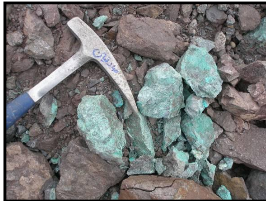
شکل ۴-۱۱- حضور مالاکیت به صورت توده‌ای در نمونه دستی
