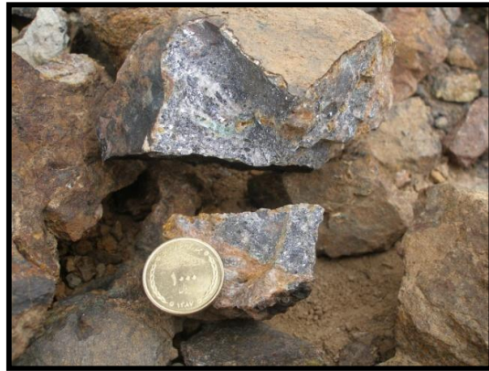
شکل ۴-۶- حضور گالن در سطح تازه شکسته شده به رنگ سفید تیره متمایل به آبی و یاس‌رزی در نمونه دستی
