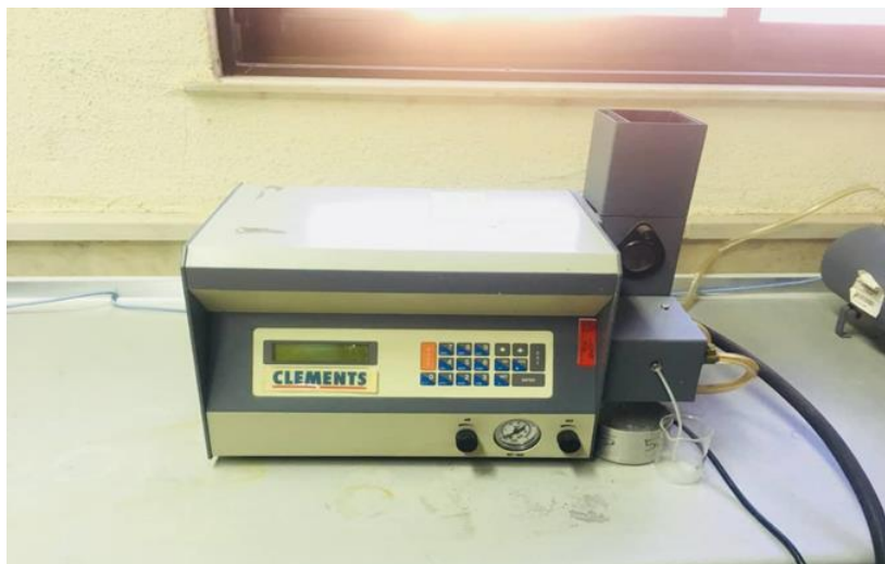
شکل ۳-۴- دستگاه اندازه‌گیری یون‌های سدیم و پتاسیم (نورسنج شعله‌ای).
