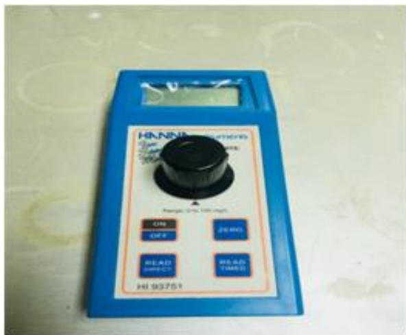
شکل ۳-۳- اندازه‌گیری سولفات نمونه‌ها با استفاده از دستگاه‌های کدورت‌سنج.
