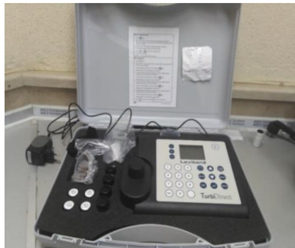
شکل ۳-۳- اندازه‌گیری سولفات نمونه‌ها با استفاده از دستگاه‌های کدورت‌سنج.
