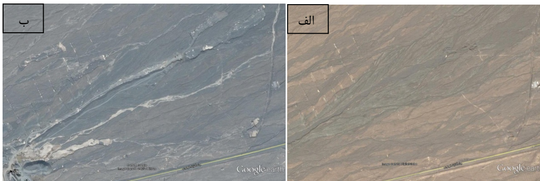
شکل 4-14- تصویر هوایی رودخانه کلات در امتداد رشته کلات قنات قصبه (الف) قبل و (ب) بعد از برداشت شن
