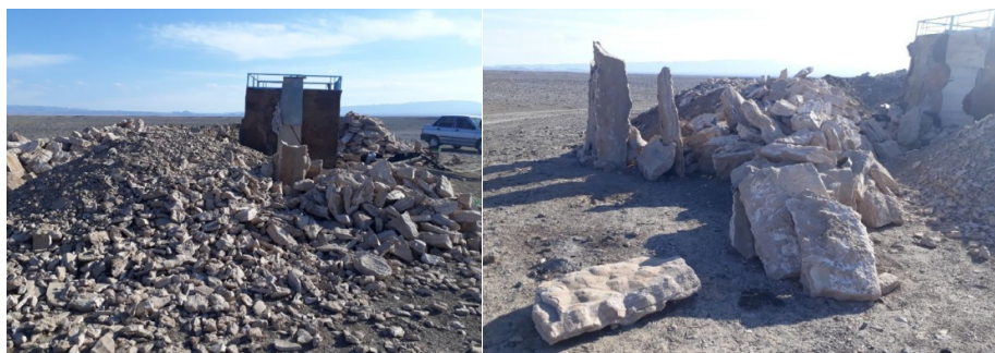
شکل 4-15- رسوبات کربناتی خارج شده حاصل از لایروبی چند چاه از قنات قصبه
