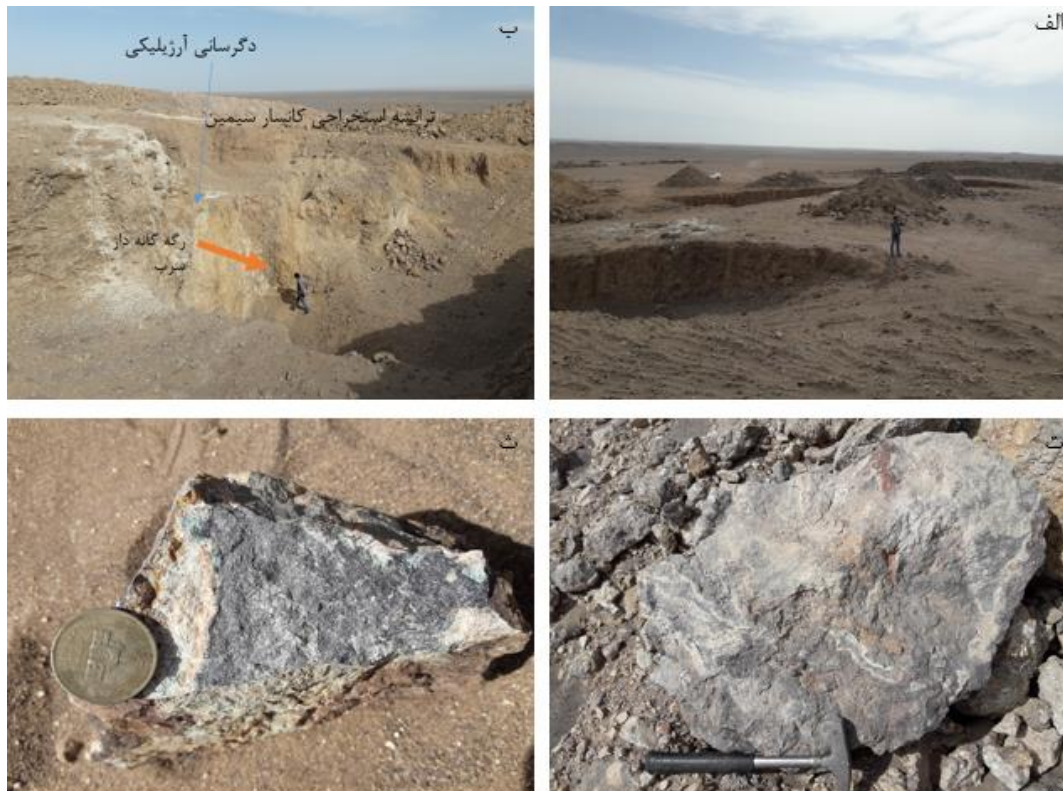
شکل ۳-۵- الف- سینه کار استخراجی کانسار سیمین (دید به سمت جنوب شرق)، ب- ترانشه استخراجی، ت- سنگ میزبان کانی‌زایی کانسار سیمین، ث- کانسنگ پرعیار (سرب) کانسار سیمین.
