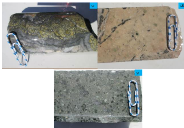
شکل ۵-۷- الف- نمونه دستی به شماره B-01 حاوی دگرسانی فیلیک، ب- نمونه دستی به شماره B-03 حاوی رگه‌های کانه‌دار سولفیدی و کوارتز دودی، پ- نمونه دستی به شماره B-02 حاوی پیریت‌های پراکنده و رگچه‌های پیریت‌دار.
