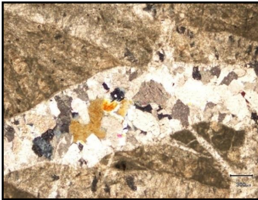
شکل ۲-۲۱- حضور رگه کربناته در لیستونیت کربناته،
