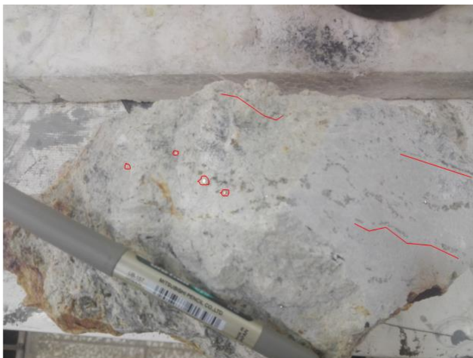
شکل ۴-۱۰: کانه‌زایی پیریت به دو شکل دانه پراکنده و رگه-رگچه‌ای در داخل گرانودیوریت‌های منطقه.
