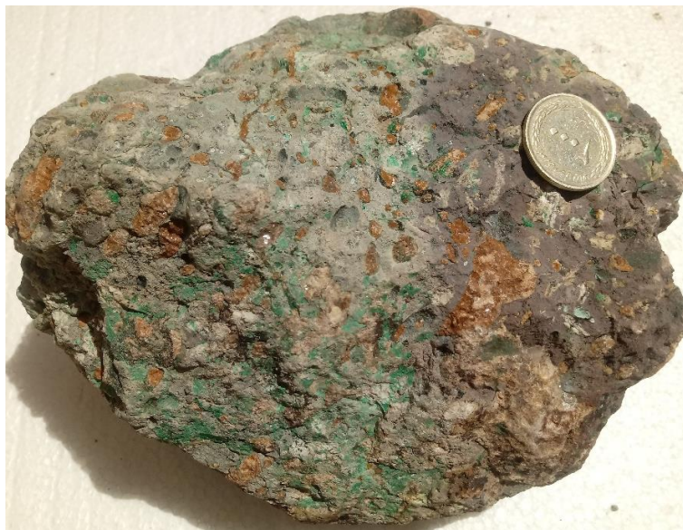
شکل ۵-۸- نمایی از کانی مالاکیت و گوتیت که بصورت حفره‌پرکن در میزبان آندزیتی کانسار مس کلوت‌بلند قابل مشاهده است.
