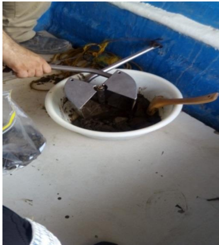
شکل (۱-۳) تصاویری از عملیات نمونه برداری توسط دستگاه ون ون گرب
