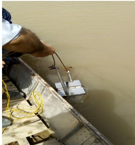
شکل (۱-۳) تصاویری از عملیات نمونه برداری توسط دستگاه ون ون گرب
