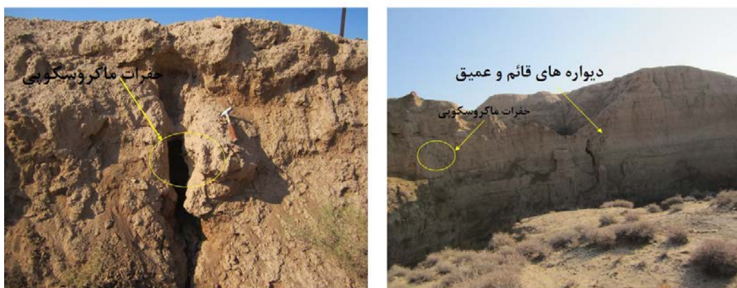
شکل ۴-۱۶ وجود حفرات ماکروسکوپی و دیواره‌های قائم و ارتفاع زیاد بعنوان شواهد رمبندگی خاک در دشت سمنان
