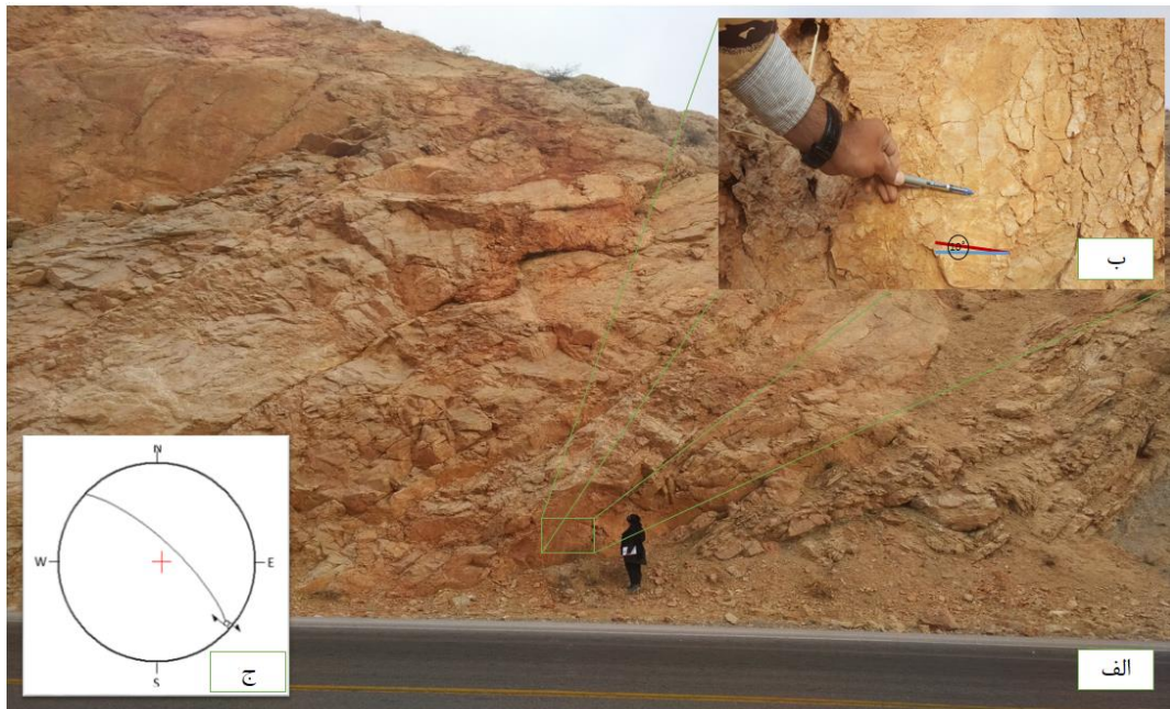
شکل ۳-۲۰- رخنمون گسل قوچان-زوباران در مقطع ۱، الف) رخنمون صفحه گسل (دید به سمت شمال شرق). ب) نمایی نزدیک از صفحه گسل با موقعیت ۷۳/۰۴۳ و خش لغزهای روی آن. خط قرمز رنگ جهت خش لغز و خط آبی جهت امتداد صفحه گسل را نشان می دهد (برداشت از فرادیواره ج) استریوگرام مربوط به گسل.
