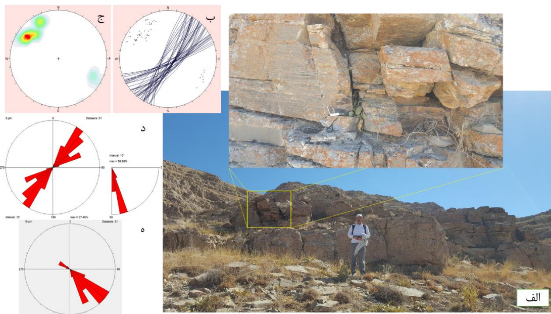
شکل ۳-۴۴- درزه‌های ایستگاه J2، الف) نمایی از درزه‌های برداشت شده (دید به سمت شمال)، ب) تصویر استریوگرافیک نشان دهنده صفحات شکستگی، ج) نمودار هم تراز قطبی درزه‌ها، د) نمودار گل سرخی شیبی و امتدادی، ه) نمودار گل سرخی جهت شیب.
