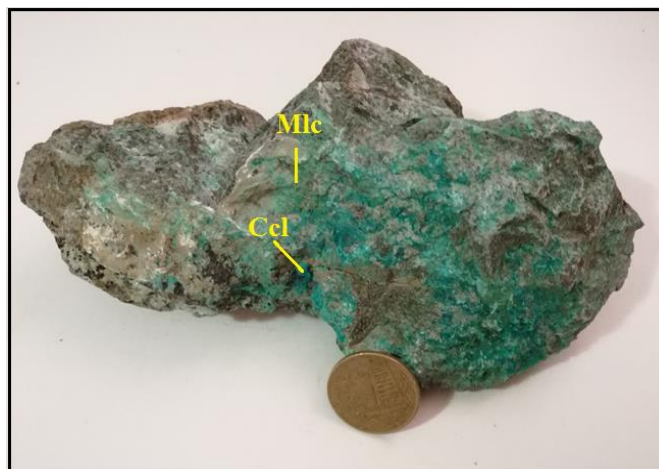
شکل ۴-۴- تصویر نمونه دستی از مالاکیت (Mlc) و کریزوکولا (Ccl) در یک نمونه کانسنگ محدوده معدنی پارسیان.
