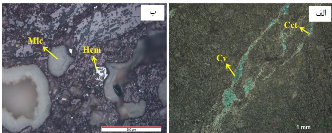
شکل ۴-۹- الف) تصویر میکروسکوپی از رگه ثانویه کوولیت (Cv)، ب) تصویر میکروسکوپی از مالاکیت (Mlc) به صورت پرکننده فضاهای بین دانه‌ای و حفرات به همراه هماتیت (Hem).
