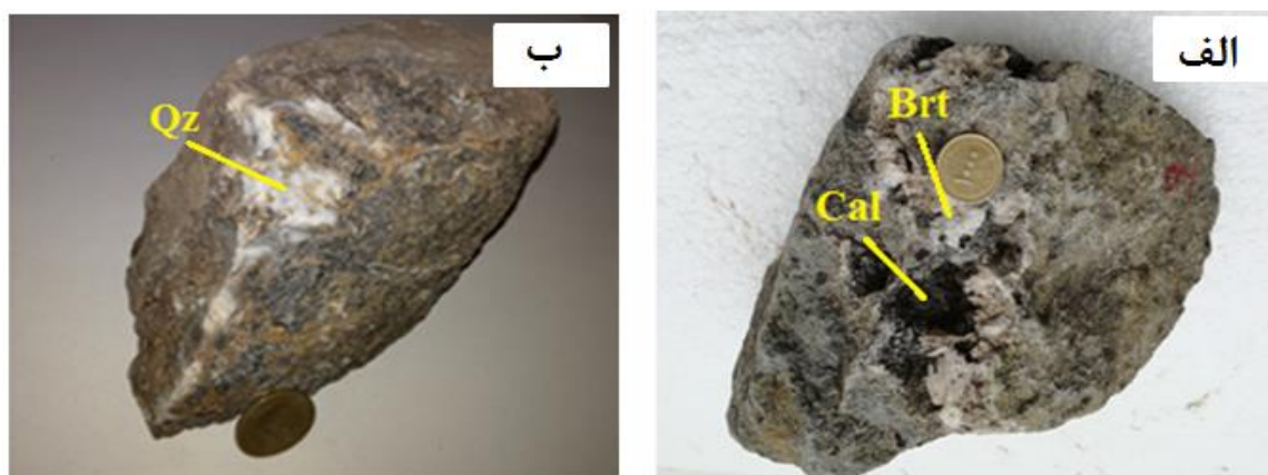
شکل ۴-۷- الف) تصویر نمونه دستی از کلسیت (Cal) به صورت پرکننده حفرات و باریت (Brt)، در میزبان توف، ب) تصویر نمونه دستی از رگه کوارتز (Qz) در میزبان توف.
