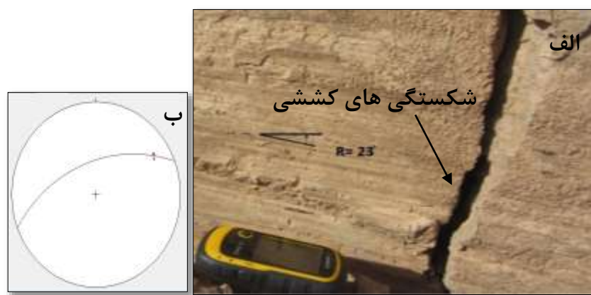
۳-۲۰-الف: سطح گسلی با رخس لغز راستا با ریک ۲۳ درجه‌ی پادساعتگرد بر روی سازند لار و حضور شکستگی‌های کششی بر روی آن. ب: استریوگرام سطح گسل با موقعیت ۲۳/۰۵۵ و رخس لغز با ریک ۲۳ درجه‌ی پادساعتگرد با موقعیت ۲۰/۰۵۹ (برداشت از فرادپواره).
