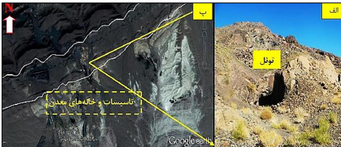
شکل ۲-۲۳: تصاویری از تونل و ترانشه حفر شده در امتداد لایه‌بندی. الف- مقیاس رخنمون صحرایی، ب- در مقیاس تصاویر ماهواره‌ای (طائفی، ۱۳۹۳).
