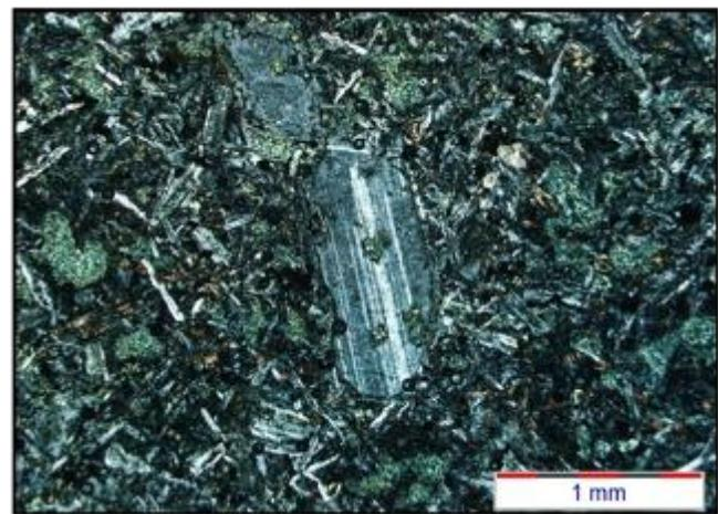
شکل ۱-۳- بافت اینترگرانولار و تصویر میکروسکوپی فنوکریست پلاژیوکلاز در زمینه میکرولیتی در بازالت‌های مورد مطالعه.
