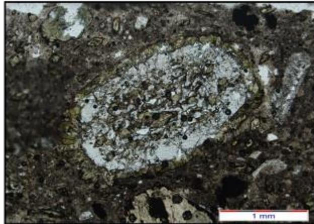
شکل ۳-۲۲- تصویر میکروسکوپی تشکیل کمربندی از بلورهای ریز آمفیبول در اطراف فنوکریست پیروکسن در سنگ های داسیتی ائوسن منطقه.
