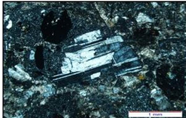
شکل ۲۵-۳- تصویر میکروسکوپی فنوکریست پلاژیولاز در کریستال لیتیک توف‌های اؤسن منطقه.
