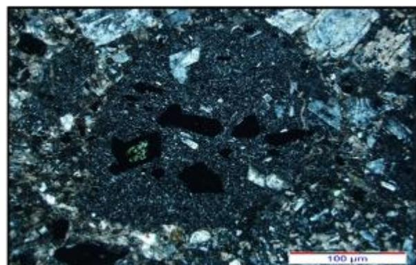
شکل ۲۷-۳- تصویر میکروسکوپی قطعه سنگی در کریستال لیتیک توف‌های اؤسن منطقه.
