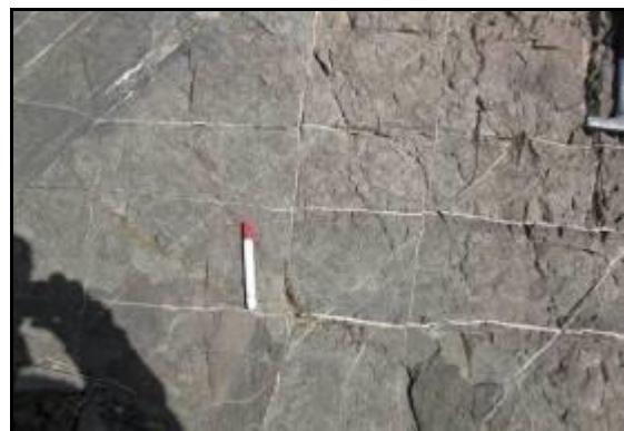
شکل ۲-۱۶- سیستم درزه‌های تقریباً عمود بر هم درون واحدهای شیلی؛ درزه‌ها توسط کلسیت ثانویه پر شده‌اند.
