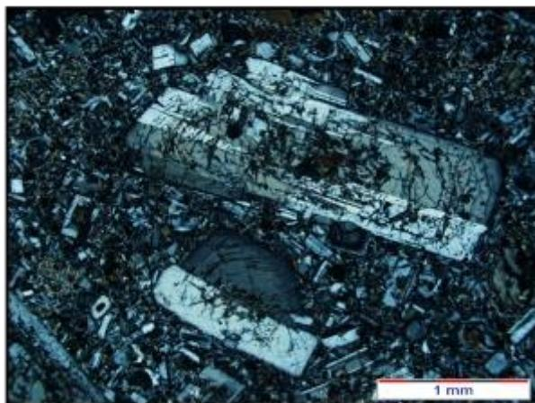
شکل ۳-۸- تصویر میکروسکوپی فنوکریست پلازیوکلاز با ماکل پلی‌سننتیک و میکرولیت‌های پلازیوکلاز اطراف آن.
