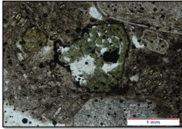
شکل ۳-۲۱- تصویر میکروسکوپی تشکیل حاشیه سوخته در اطراف بلور آمفیبول در داسیت های ائوسن.
