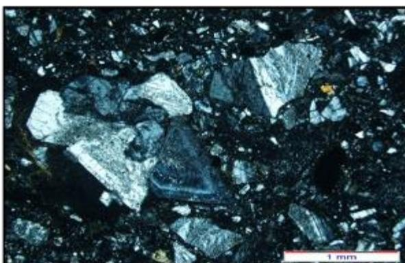
شکل ۲۸-۳- تصویر میکروسکوپی اجتماع بلورهای پلاژیولاز در کریستال لیتیک توف‌های اؤسن منطقه؛ برخی از بلورهای پلاژیولاز منطقه‌بندی ترکیبی دارند.
