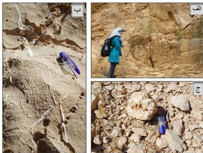
شکل ۳-۵۹- تصاویری از درزه‌ها در آهک‌های کرتاسه، الف- درزه‌های کششی برشی دید به شرق، ب-پرشدگی در درزه-ها به وسیله کلسیت، ج- آثار کلسیت شدگی در آهک‌های کرتاسه بصورت سنگ‌شدگی
