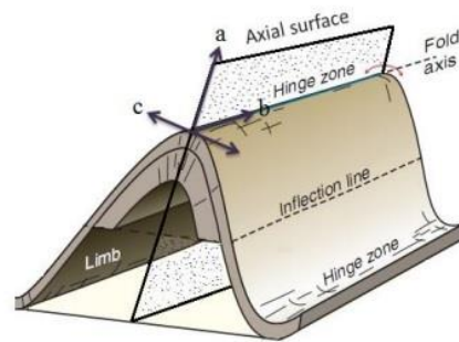
شکل ۳-۸-الف- محورهای تقارن در ارتباط با چین خوردگی (Fossen, 2010). ب- توسعه‌ی انواع مختلف شکستگی‌ها در ارتباط با چین خوردگی (Ramsay & Huber, 1987).
