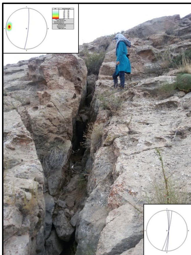
شکل ۳-۵۳ تصویر صحرایی از شکستگی با بازشدگی ۳۰ سانتی متر به همراه تصویر سیکلوگرافیک و نمودار هم‌تراز قطب شکستگی (دید عکس به جنوب غرب).
