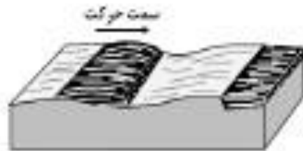
شکل ۳-۱۳- نمایش پله‌های گسلی به صورت بلوک دیاگرام (Allmendinger, 1989).
