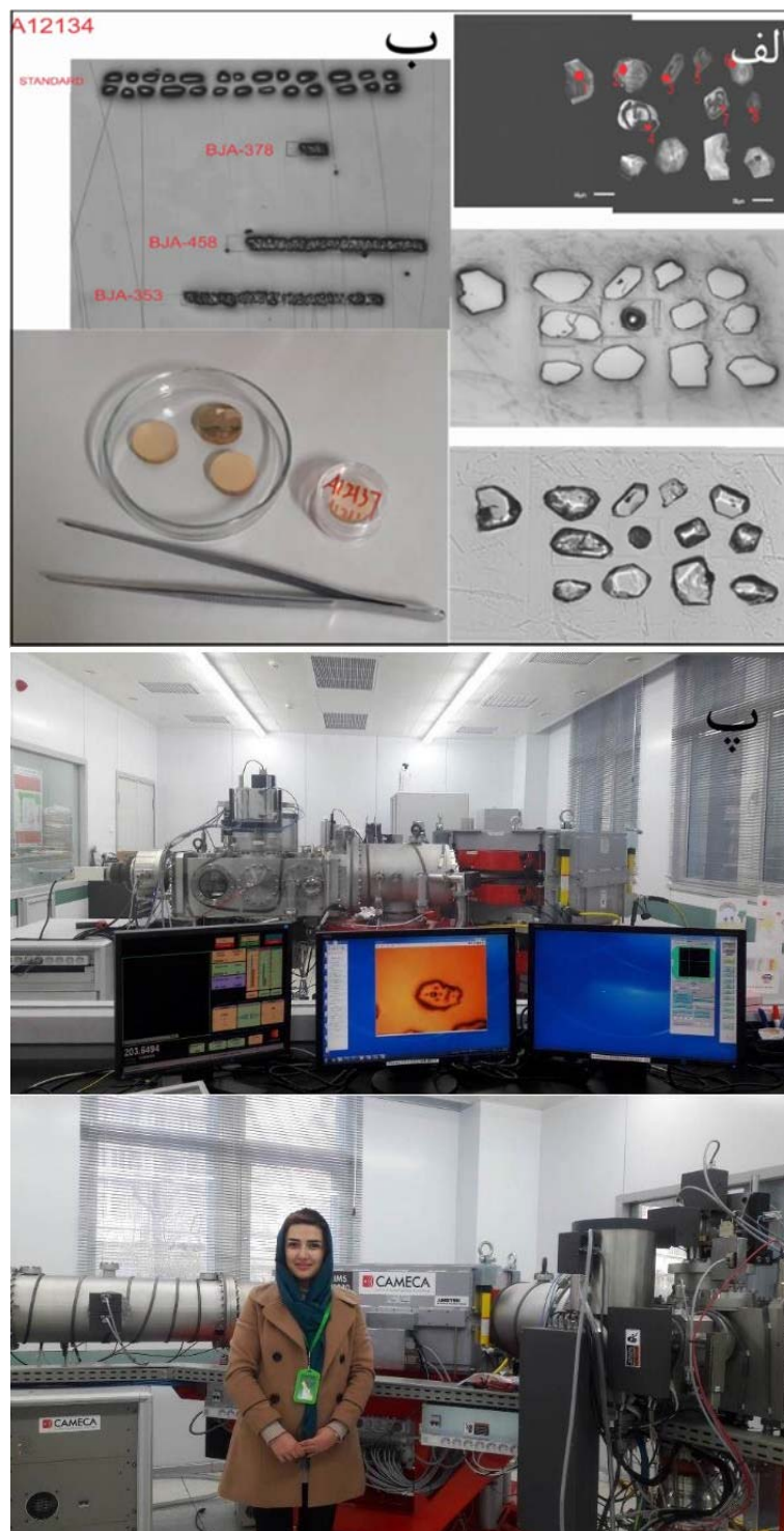
شکل ۱-۷-الف) به ترتیب از بالا به پایین تصاویر کاندولومینسانس، انعکاسی و عبوری از زیرکن‌ها؛ ب) تصویر مونت زیرکن‌های قالب گیری شده در رزین مخصوص با پوشش طلا همراه با تصویر میکروسکوپی آن؛ پ) تصاویری از دستگاه SIMS در آزمایشگاه SIMS مؤسسه زمین‌شناسی و ژئوفیزیک آکادمی علوم چین.
