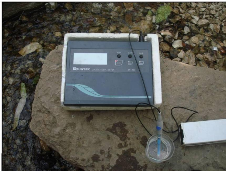
شکل ۳-۴- اندازه‌گیری اسیدیته چشمه‌ها
