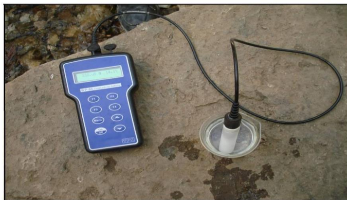
شکل ۳-۳- اندازه‌گیری هدایت الکتریکی چشمه‌ها
