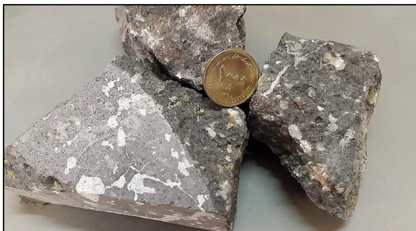
شکل ۲-۱۹) ساخت بادامکی پر شده با کلسیت و سیلیس در واحد بازالتی کوه پیشسار
