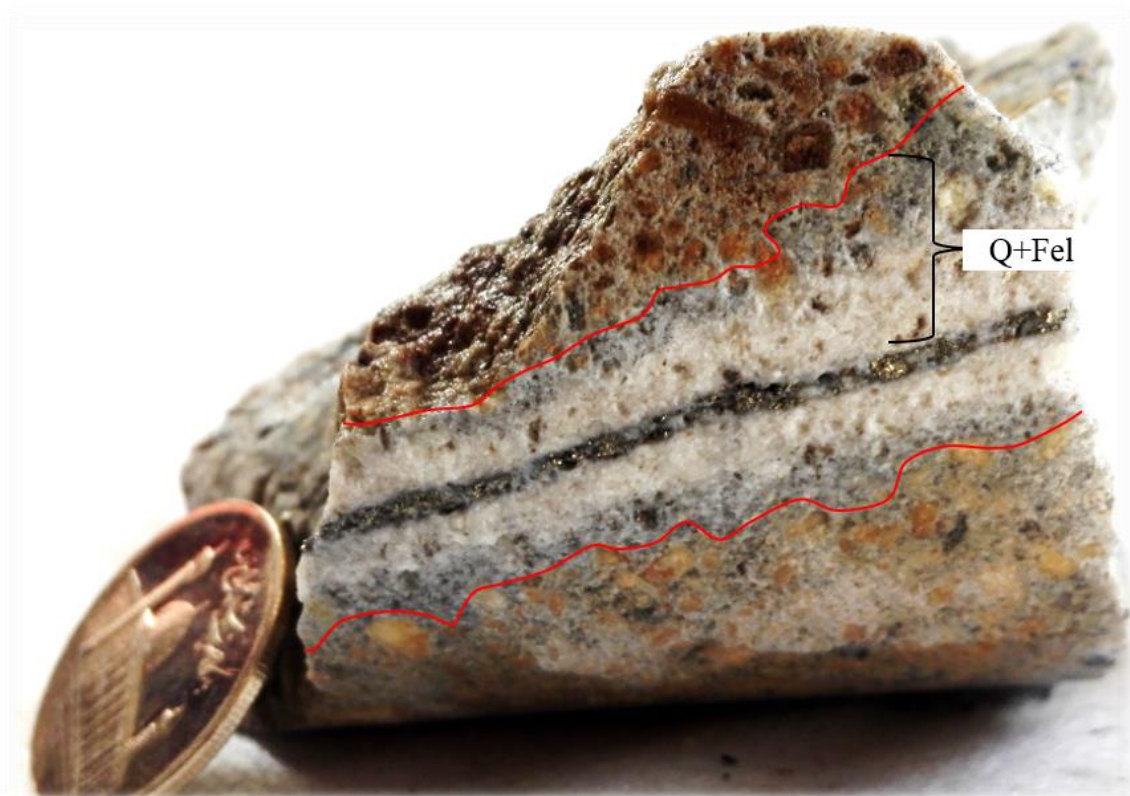
شکل ۴-۱۶. تصویر نمونه دستی از رگه‌ی نوع D و هاله‌ی سیلیسی - سریسیتی اطراف آن.
