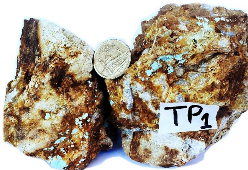
شکل ۴-۱۴. نمونه دستی مربوط به کانی‌های زون سوپرژن: کریزوکولا (فیروزه‌ای)، گوئتیت (قرمز آجری) و لیمونیت (زرد و نارنجی).
