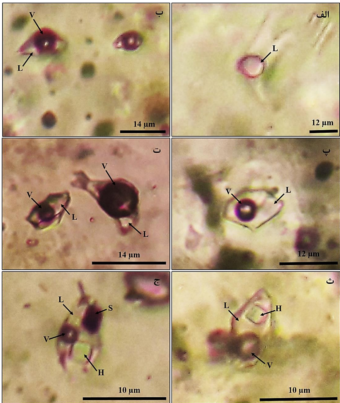
شکل ۶-۴. انواع میانبارهای سیال به همراه اشکال مختلف حضور آنها در نمونه‌های مورد مطالعه: الف) میانبار تک فازی مایع (L) با شکل کروی، ب) میانبار نوع بخار-مایع (VL)، با اشکال کشیده، پ) میانبار دوفازی نوع مایع-بخار (LV)، به صورت نیمه‌شکل‌دار، ت) اشکال کشیده و تمام‌شکل‌دار میانبارهای نوع بخار-مایع (VL) و مایع-بخار (LV)، ث) میانبارهای سه فازی مایع-بخار-هالیت (LVH) و ج) میانبارهای چهار فازی مایع-بخار-هالیت-جامد (LVHS).
