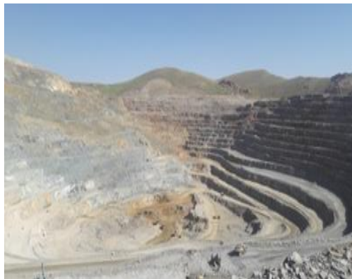
شکل ۱-۵: عملیات استخراج به روش پلکانی در معدن روی-سرب انگوران
