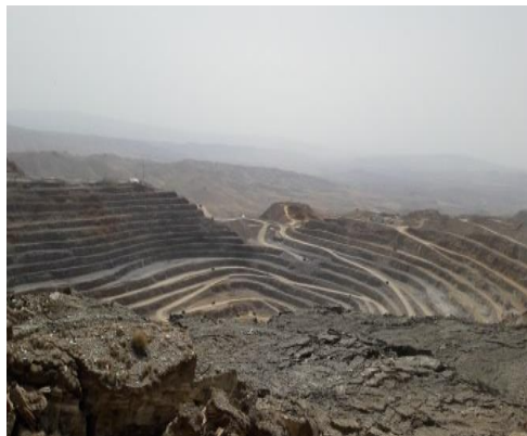
شکل ۱-۵: عملیات استخراج به روش پلکانی در معدن روی-سرب انگوران
