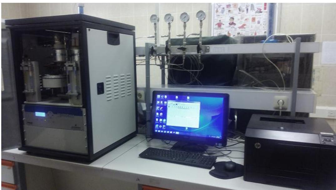
شکل (۳-۲) : دستگاه آنالیز پیرولیز راک-اول (آزمایشگاه پیرولیز راک-اول، واحد ژئوشیمی، پژوهشگاه صنعت نفت، ۱۳۹۶)
