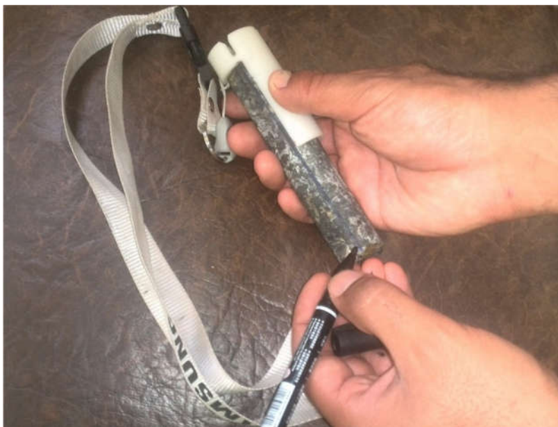
شکل ۴-۸- نحوه علامت زدن روی مغزه‌های به‌دست‌آمده.
