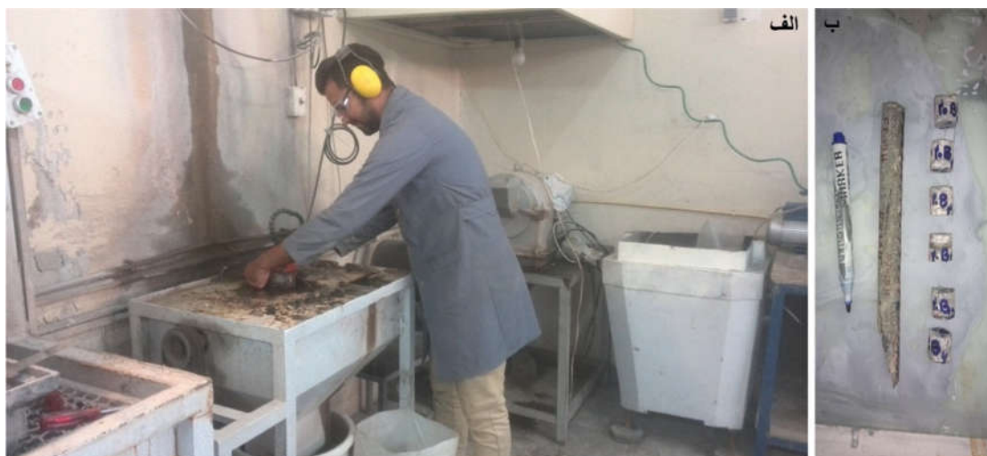
شکل ۴-۴- الف) برش نمونه‌ها در کارگاه سنگ دانشگاه صنعتی شاهرود. ب) تصویری از یک مغزه که به قطعات ۲۲ میلیمتری برش خورده است.
