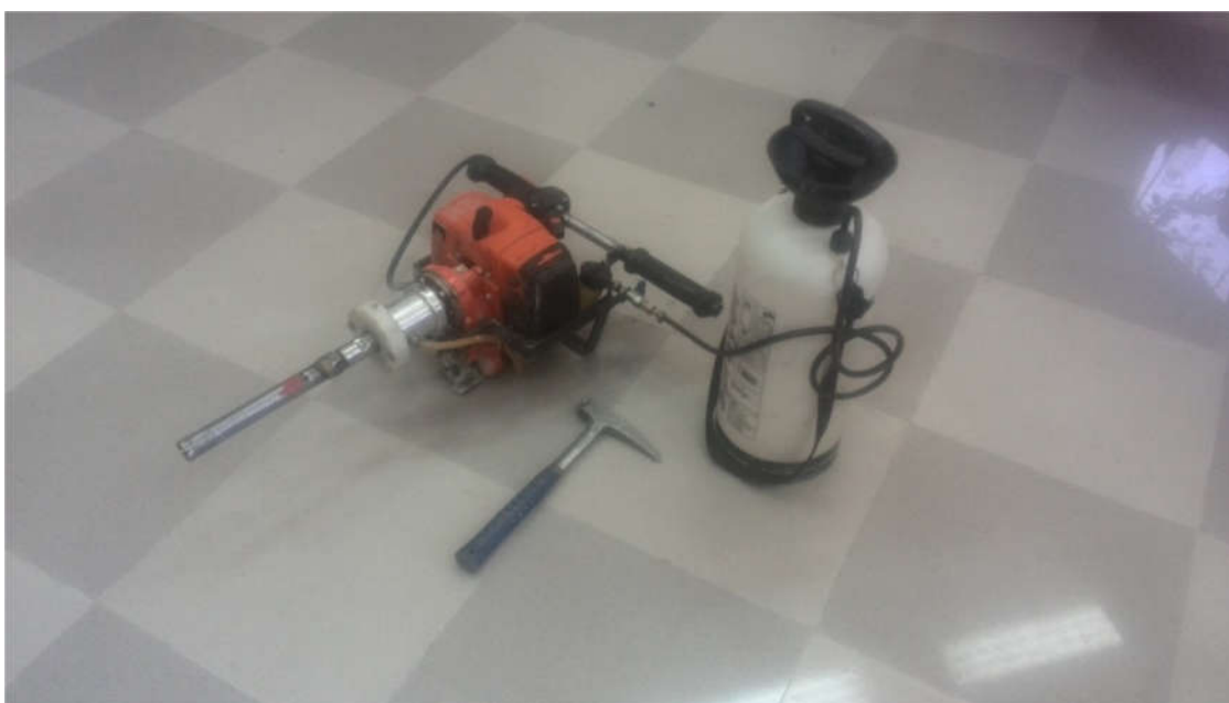
شکل ۴-۵- نمایی از دستگاه مغزه گیر به همراه پمپ آب خنک کننده سر مته
