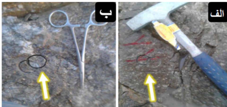
شکل ۴-۶- ترسیم خط یا ایجاد اشکال دایره‌ای برای باز گرداندن مغزه به حالت اولیه (در صورتی که مغزه شکسته یا جابه‌جا شود).
