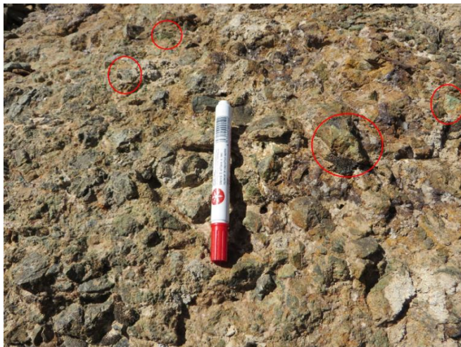
شکل ۳-۳: تصویر صحرایی از زون برشی، سولفیدهای اولیه شامل پیریت و کالکوپیریت بین قطعات برش به کانی‌های ثانویه شامل اکسیدهای آهن و مالاکیت دگرسان شده‌اند.
