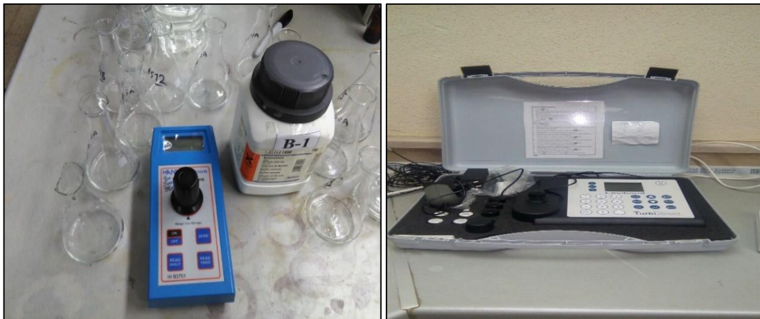
شکل ۳-۳- اندازه‌گیری سولفات نمونه‌ها با استفاده از دستگاه‌های کدورت سنج
