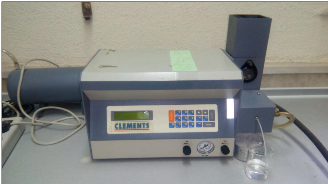
شکل ۳-۵- دستگاه اندازه‌گیری یون‌های سدیم و پتاسیم (نورسنج شعله‌ای)
