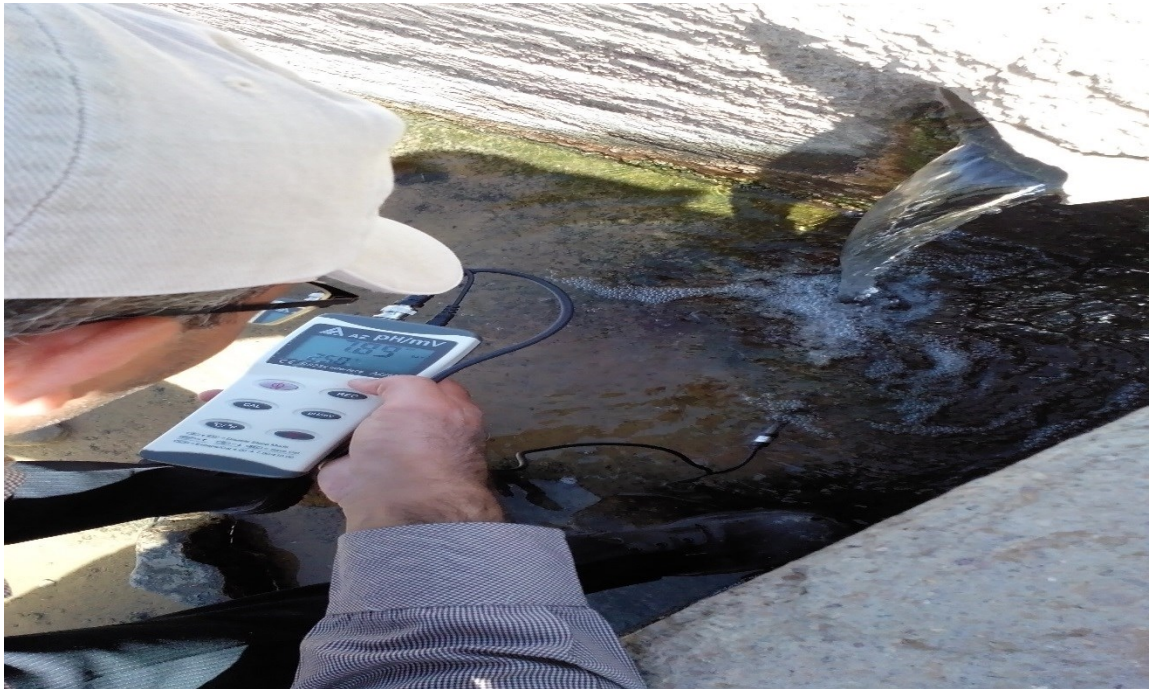
شکل ۳-۴- اندازه‌گیری pH قنات خلیل‌آباد
