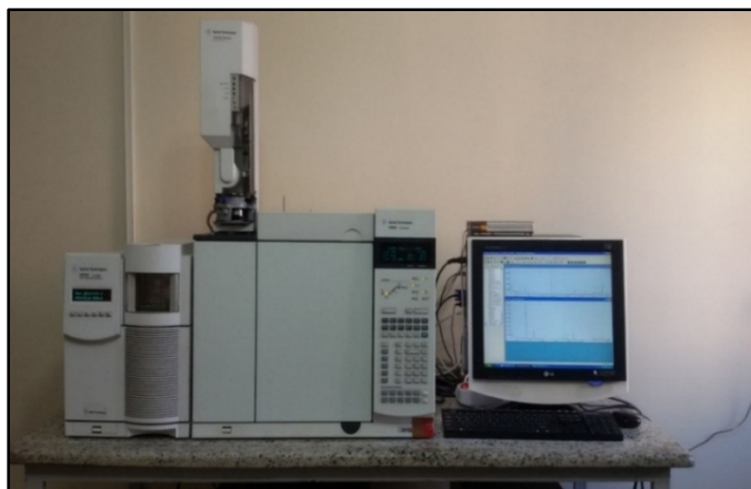
شکل ۳-۷ - آنالیز پارمترهای هیدروکربنی با استفاده از دستگاه کروماتوگرافی گازی مجهز به آشکار ساز جرمی
