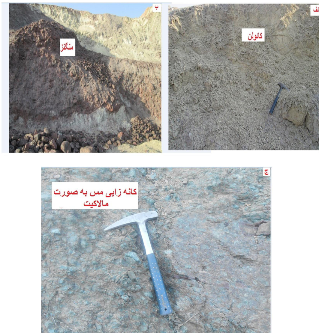
شکل ۲-۲۴- الف) نمایی از معدن کائولن در جنوب غرب سبزوارب) تصویری از معدن منگنز ذاکری که در آن توف و توف‌های کربناتی میزبان کانۀ زایی منگنز می‌باشد، ج) در واحدهای آتشفشانی- رسوبی کانۀ زایی مس به صورت مالاکیت دیده می‌شود.
