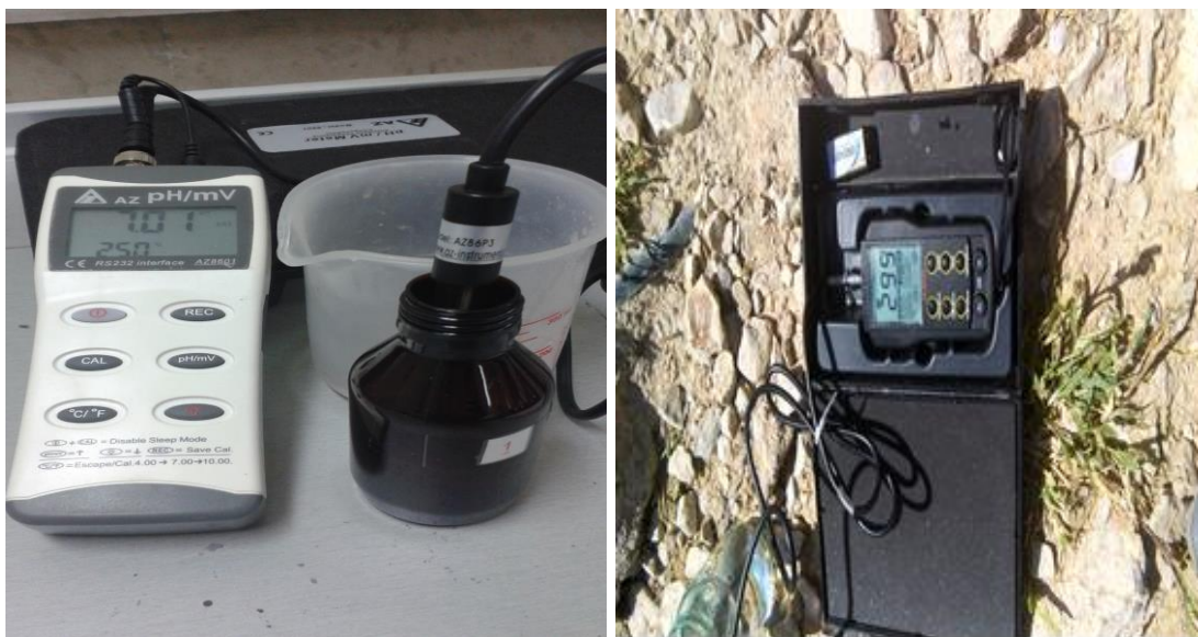
شکل ۲-۳- دستگاه‌های اندازه‌گیری EC و pH (سمت راست، هدایت‌سنج الکتریکی، سمت چپ، pH متر)
