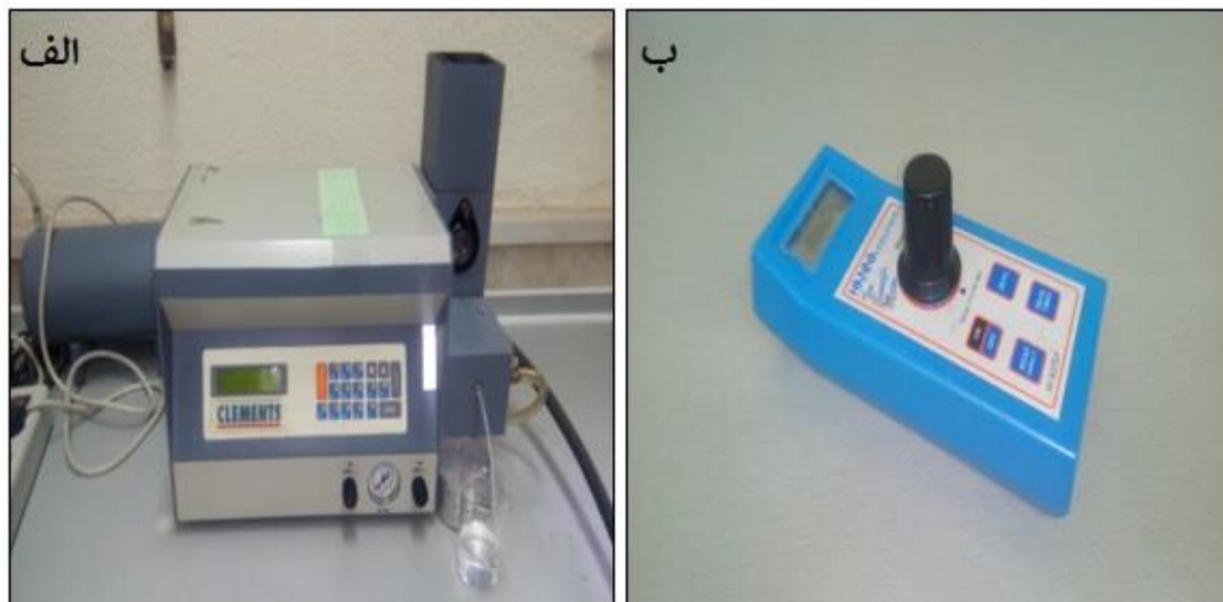
شکل ۳-۴: دستگاه فلیم فتومتر (الف) و دستگاه اندازه‌گیری یون سولفات (ب)
