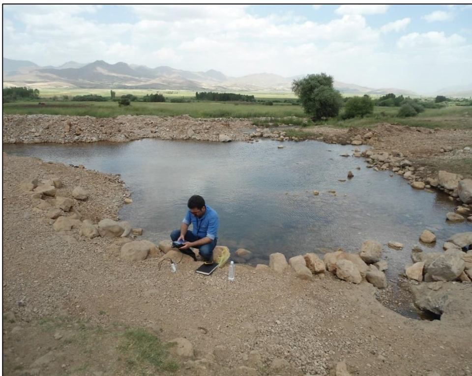
شکل ۲-۳: اندازه گیری پارامترهای هدایت الکتریکی و pH در صحرا
