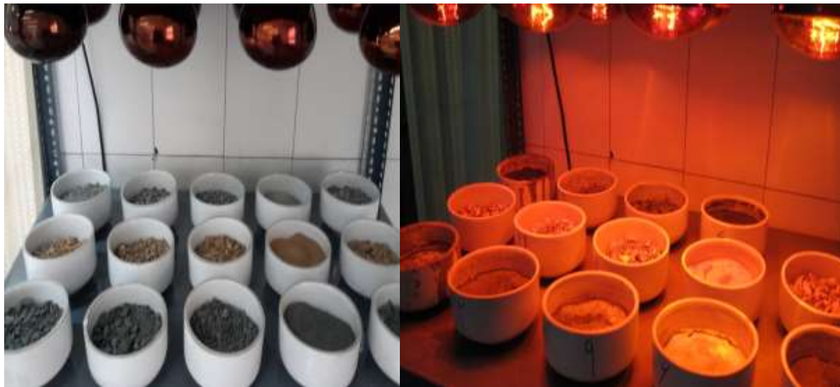
شکل ۳-۳ وضعیت لامپ‌های مادون قرمز و نمونه‌های باطله در قبل و بعد از ریختن محلول‌های شیمیایی به مدت سه ماه مراحل انجام آزمایش لیچینگ در زیر شرح داده شده است:
