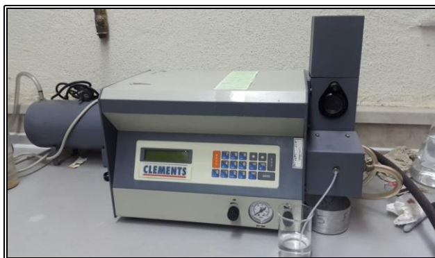
شکل ۳-۶: اندازه‌گیری غلظت یون‌های سدیم و پتاسیم با استفاده از دستگاه نوری شعله‌ای
