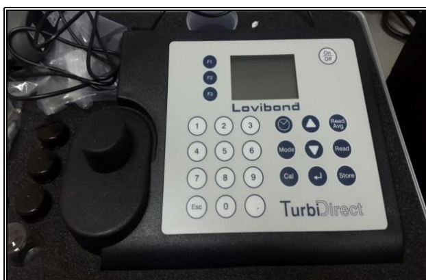
شکل ۳-۷: اندازه‌گیری غلظت یون سولفات با استفاده از دستگاه کدورت سنج
