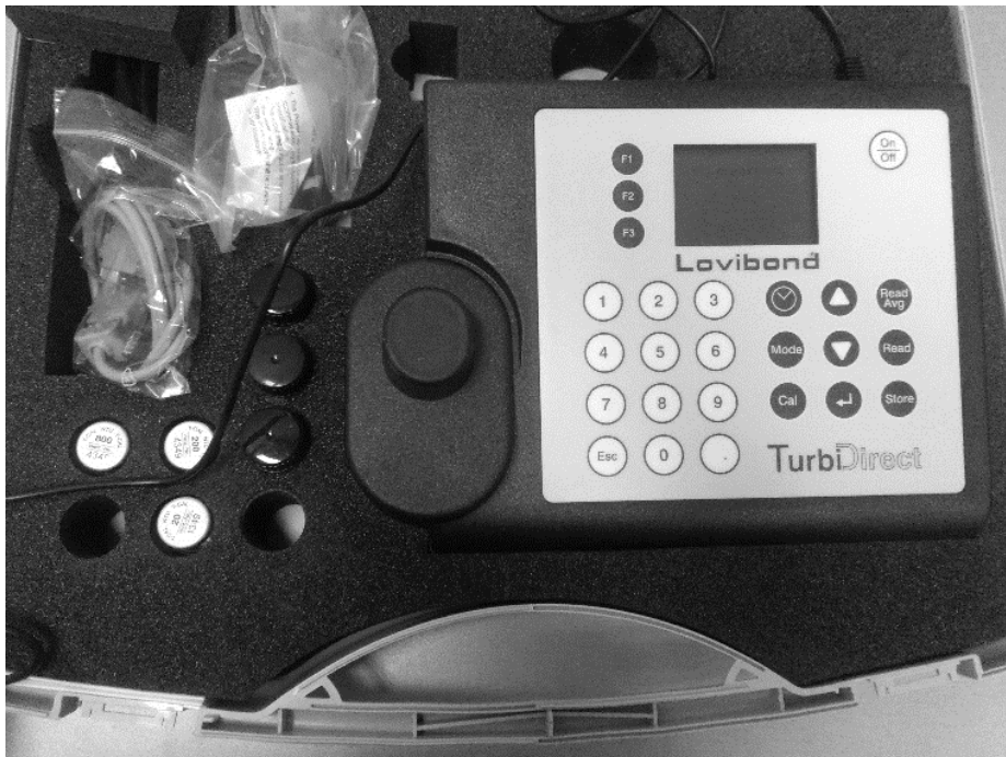
شکل ۳-۳- اندازه‌گیری مقادیر یون سولفات با استفاده از دستگاه توربیدی متر
