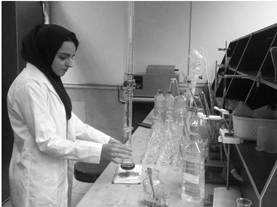
شکل ۳-۲- اندازه‌گیری یون‌های اصلی با استفاده از روش تیتراسیون
