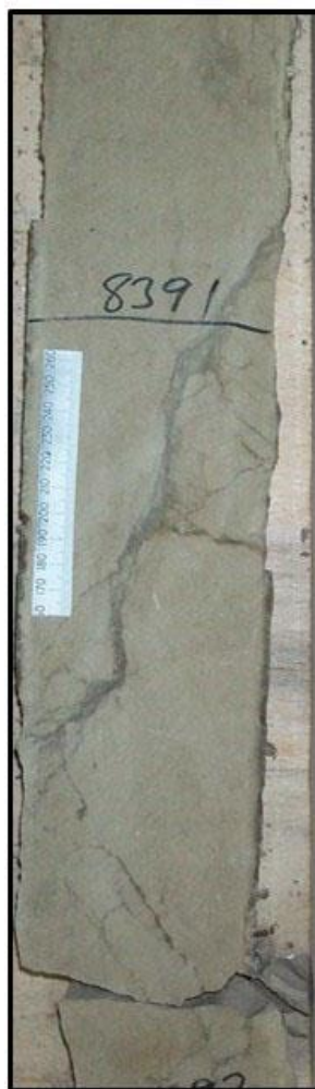
شکل ۳-۱۰- نمونه‌ای از شکستگی‌های بسته در لاگ FMI و مقایسه‌ی آن با مغزه‌ی به دست آمده از همین اعماق
