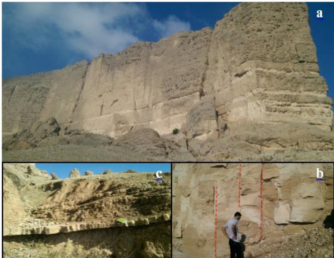
شکل ۳-۵۶- تصویر از لایه بندی و درزه های موجود در سازند لهری. (a) - لایه بندی سازند لهری و استریوگرام لایه بندی های موجود در آن با دید به سمت شمال (b) - درزه های عمود بر لایه بندی و روند گسل با دید به سمت شمال ، (c) - درزه های موازی با روند گسل و لایه بندی با دید به سمت شرق
