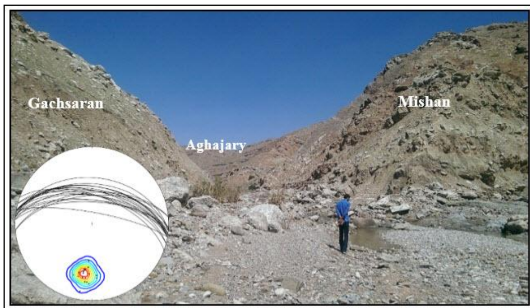
شکل ۳-۷- رخنمون سازندهای موجود در مسیر D-D' و استریوگرام لایه‌بندی (جهت دید به سمت شمال). در این پیمایش با حرکت از شمال شرق به جنوب غرب اندازه‌گیری‌های ساختاری از رخنمون لایه‌بندی سازندهای آغاجاری و میشان انجام شد. همان‌گونه که در تصویر استریوگرافیک مشاهده می‌شود، داده‌های برداشت‌شده در این مسیر (پیوست ۵) نیز نشان‌دهنده‌ی لایه‌های مربوط به یال شمالی تاقدیس و با شیب به سمت شمال- شمال شرق می‌باشند. (شکل ۳-۹)
