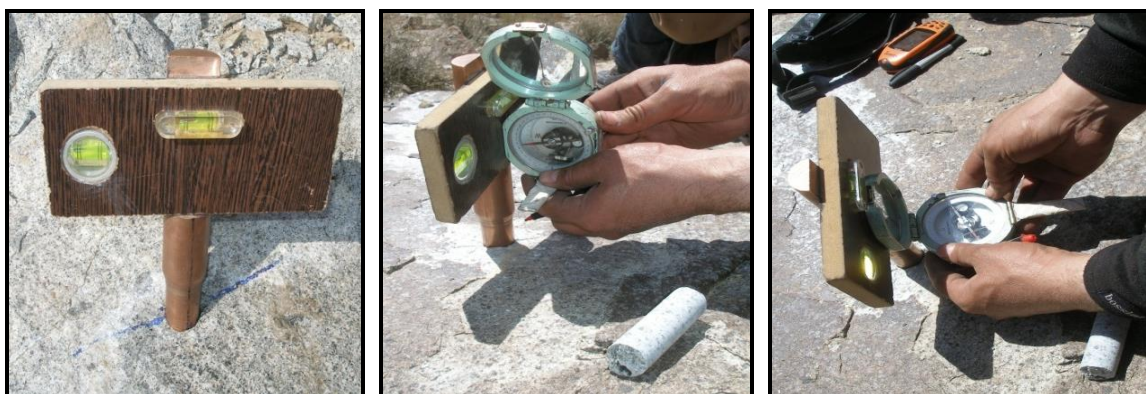
شکل ۳-۱۱- در این تصاویر نحوه برداشت شیب و جهت شیب، توسط کمپاس و ترازیاب مغزه نشان داده شده است.
