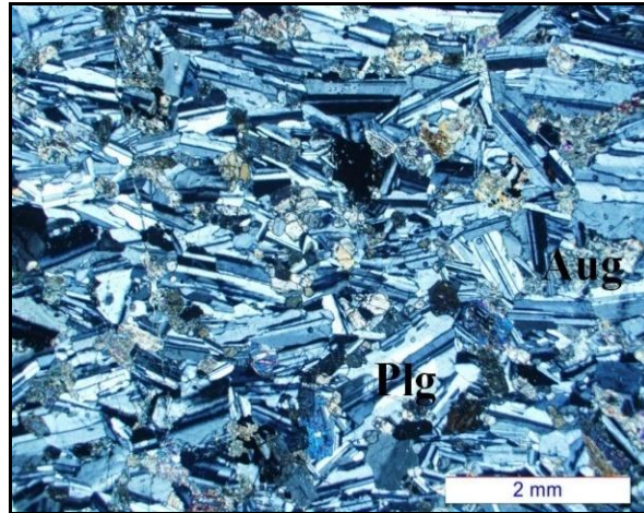
شکل ۲-۱۲- تصویری از بافت دانه‌ای شکل دار تا نیمه شکل دار حاصل از اجتماع بلورهای پلاژیوکلاز و اوژیت (XPL).
