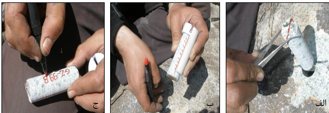
شکل ۳-۱۲- الف- نحوه خارج ساختن مغزه از زمین بعد از مشخص کردن شیب و جهت شیب ب- نحوه استفاده از نیم لوله پلاستیکی برای هاشور زدن مغزه. ج- شماره گذاری مغزه.
